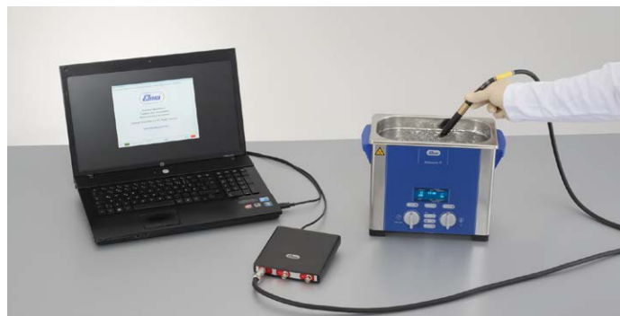
Elmasonic P 30H während der Kavimetermessung
